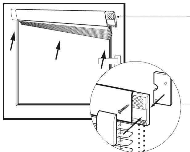
5. Просверлить два отверстия в нижнем штапике.
